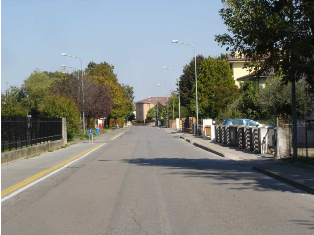
Foto 56. Via Ruffini: pista ciclabile/pedonale a raso sulla sinistra, marciapiedi sulla destra (differenza di quota di circa 10 cm - raccordi in prossimità degli accessi)
