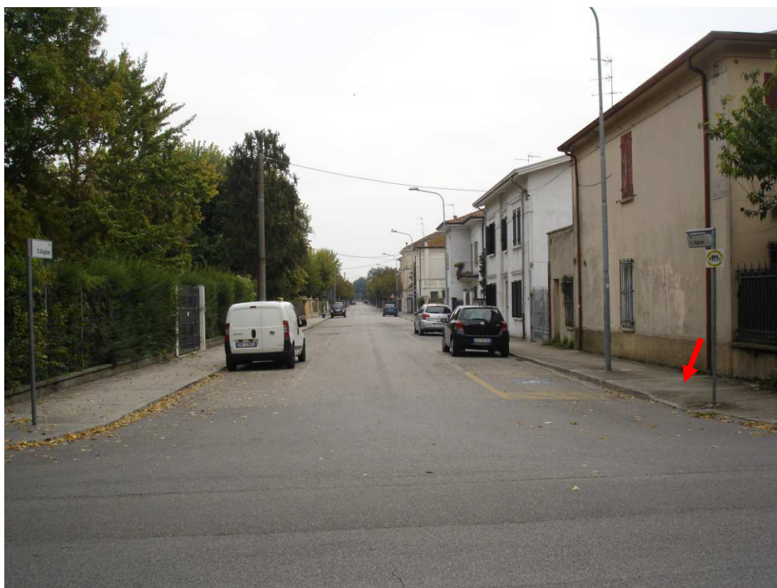
Foto 64. Via Dante in prossimità dell'incrocio con via Dugoni. Marciapiedi pedonali ambo i lati, parcheggio disabile a destra con raccordo tra marciapiede (in quota +10 cm rispetto al piano strada) e superficie carrabile (evidenziato in foto).
